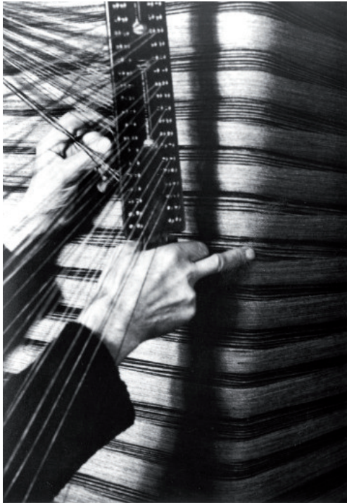
Abb. 37 und 38 Handweber beim Zetteln (Schweifen, Schären)
