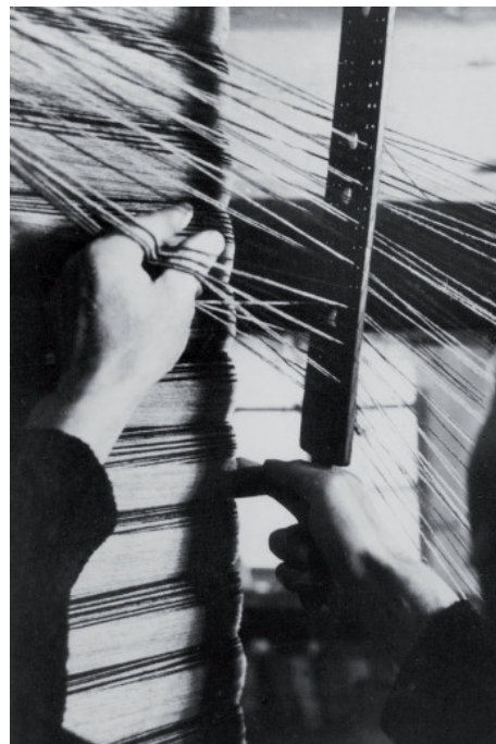
Abb. 36 Das Schränken am Zettelbrett vor dem Zettelrahmen
