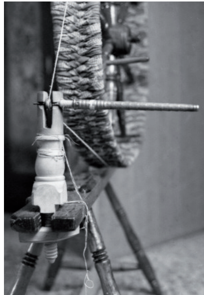
Abb. 24 und 25 Links ein Spulrad mit Spulradkasten zum Zettelspulen; rechts eine Spulrad-Docke zum Schuss spulen auf dem selben Spulrad. Auf die Spindel schiebt die Spulerin die Schußspulenhülse.
