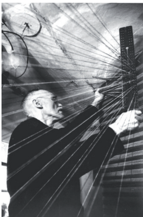
Abb. 39 und 40 Handweber beim Zetteln (Schweifen, Schären)
