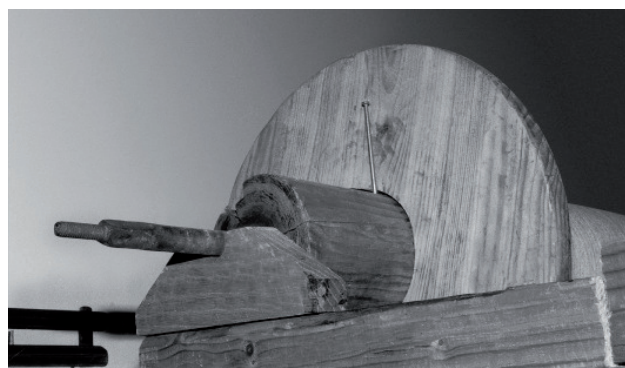
Abb. 56 Im Osten des Untersuchungsgebietes übliche Kettbaumform mit einer Eisenachse mit Vierkantende. Das Holz darunter wird Hauch genannt (Roßbacher Heimatstuben, Rehau)
