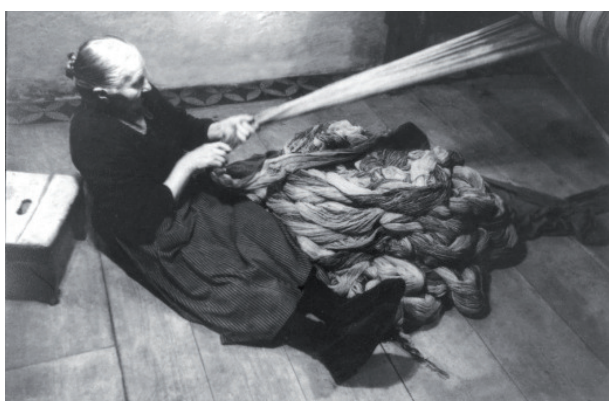
Abb. 48 Um den Zettel wirklich straff halten zu können, hat sich diese Frau auf den Boden gesetzt
