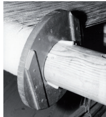
Abb. 47 Kettbaumscheibe auf dem Kettbaum
